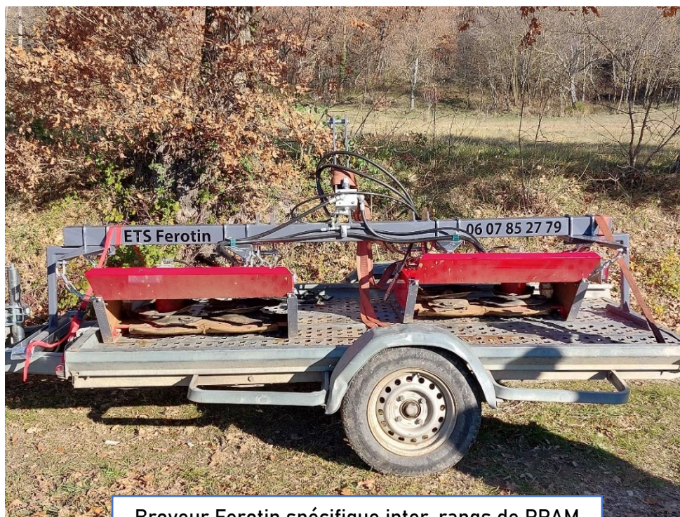
Broyeur Ferotin spécifique inter-rangs de PPAM
